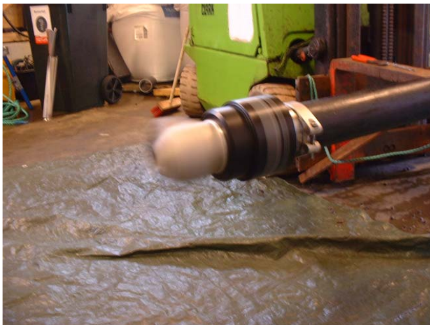
Bilde 2. Akva turbospreader på fôrslange og i rotasjon.
